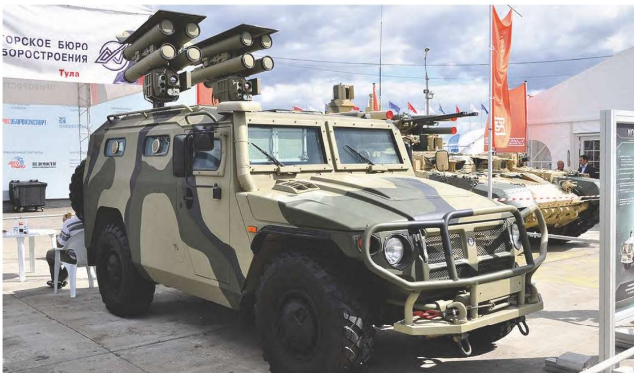
Авиасалон МАКС-2011 стал премьерным для еще одной разработки российских оружейников. «Корнет-ЭМ» — самоходный противотанковый ракетный комплекс, который выглядит настоящим пришельцем из войн будущего. Автомобиль оборудован двумя пусковыми установками общим боекомплектом в восемь ракет.
