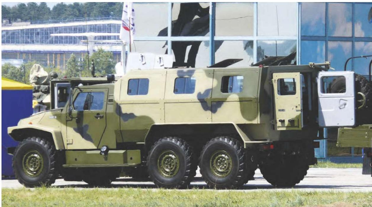
**ВПК-39273 “Волк-III”** – автомобиль (6Х6) с функциональным модулем (10,3 м.куб.) для перевозки личного состава, монтажа оборудования, с заданным уровнем защиты. По словам разработчиков, автомобиль был собран за два дня до открытия выставки МВСВ-2010.
