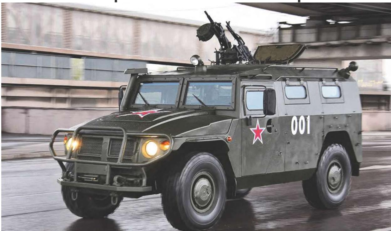
Боевой армейский внедорожник ГАЗ-2330 «Тигр» может использоваться в условиях города: собственно, поначалу им как раз заинтересовалось руководство СОБРа. В крыше машины установлены два кронштейна под пулемёты, оператор которых работает из врачающегося люка.
