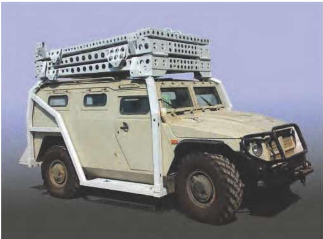
Спецавтомобиль «Тигр» «Абайм-Абанат» со штурмовым трапом в походном положении
