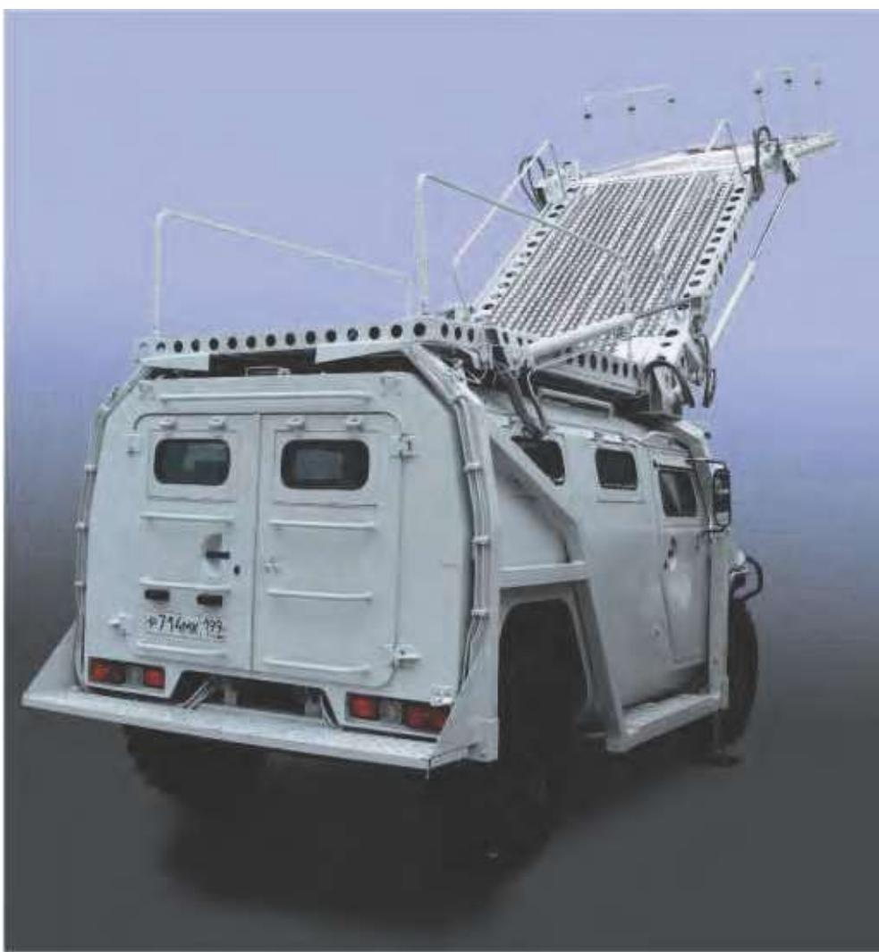
Спецавтомобиль «Тигр» «Абайм-Абанат» с развернутым штурмовым трапом
