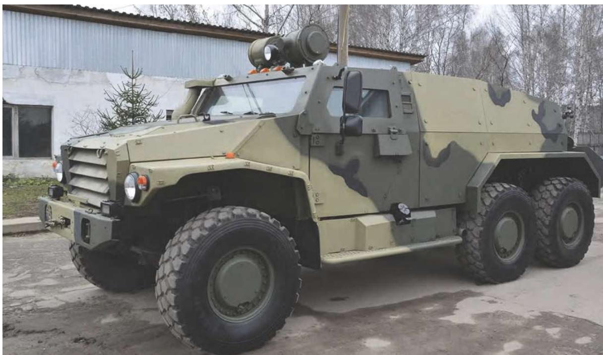
«Волк» относится к автомобилям повышенной защищённости, а значит, может без проблем прорваться в самую гущу боя. Конструкция машины модульная — в зависимости от текущих задач, на шасси могут быть установлены любые необходимые в данный момент модули, даже в полевых условиях. Таким образом, «Волк» может превратиться в атакующий бронеавтомобиль, или стать платформой для модулей связи.
