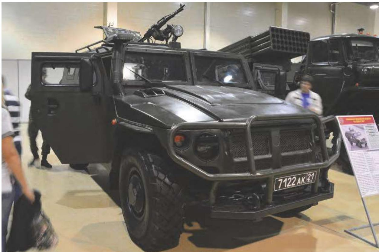
Армейский «Тигр» оснащается дизельным двигателем Cummins B205 мощностью 205 л.с. Также возможно использование мотор ГАЗ-562 мощностью 110 л.с. Двигатель сопряжён с механической коробкой передач и трансмиссией, передающей крутящий момент на все четыре колеса. Двигатель обеспечивает максимальную скорость на шоссе порядка 125 км/ч. Полная масса машины – 7,2 т, из которых 1,2 т приходится на груз.
